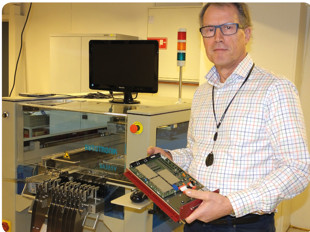
I produksjonsavdelingen finner vi en egen monteringsautomat, som ble kjøpt inn for halvannet år siden. Automaten har utvidet kamerafunksjon for inspeksjonsmuligheter. Nylig er også loddeovnen skiftet ut, så man kan kjøre full sertifisering på alle loddetyper – fra blylodding til RoHS-godkjent. Kortet som Werner Fuchs viser frem er det tidligere omtalte trikkesystemet, som er blitt miniaturisert fra "koffertstørrelse".
